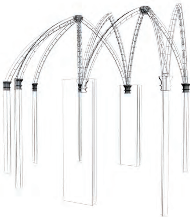
Obr. 24 Rekonstrukce gotické klenby - drátěný model, vizualizace L. Kolarčíková, 2011
